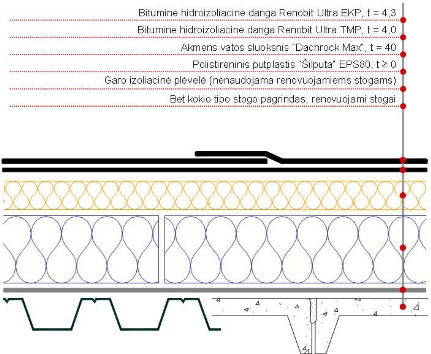
Bituminė hidroizoliacinė danga Renobit Ultra EKP,  $t = 4,3$
