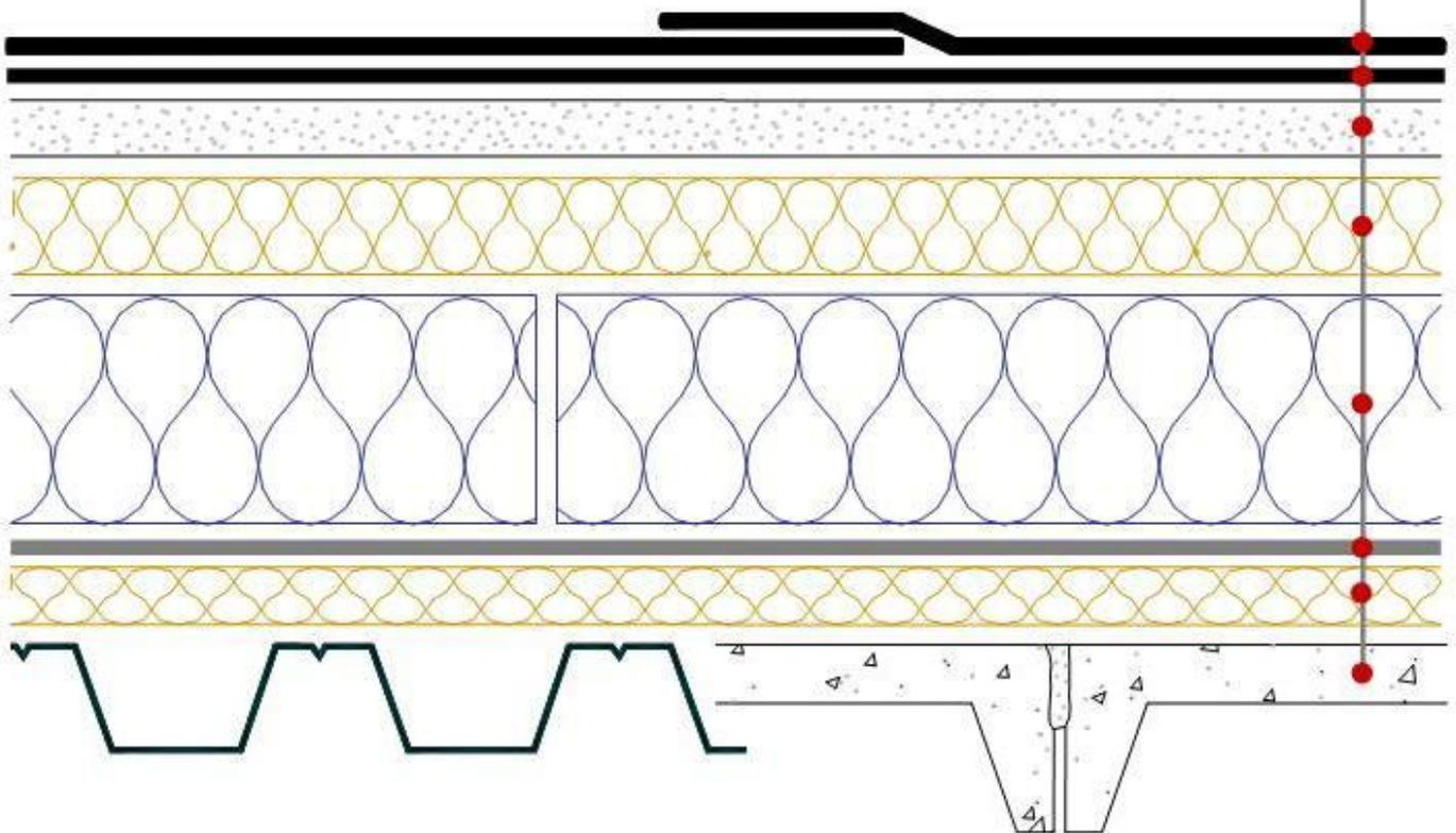
Bituminė hidroizoliacinė danga Renobit Ultra EKP,  $t = 4,3$
