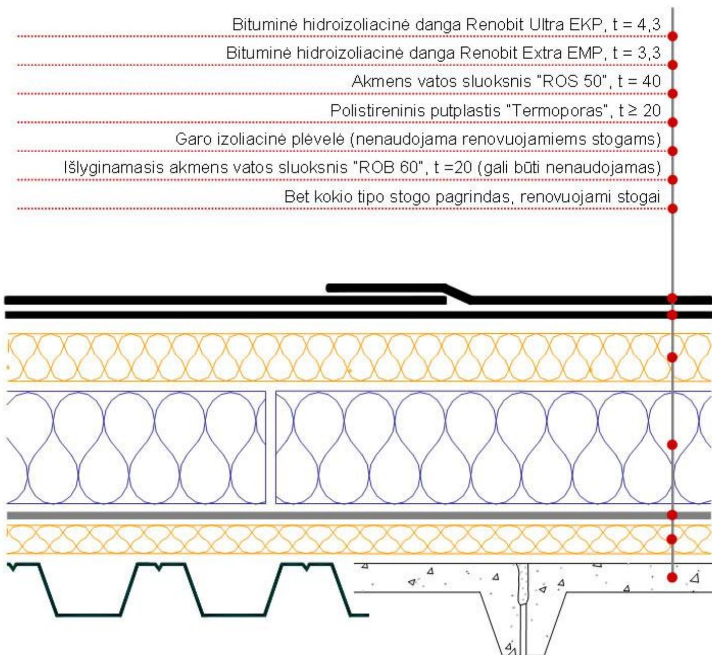
Bituminė hidroizoliacinė danga Renobit Ultra EKP,  $t = 4,3$
